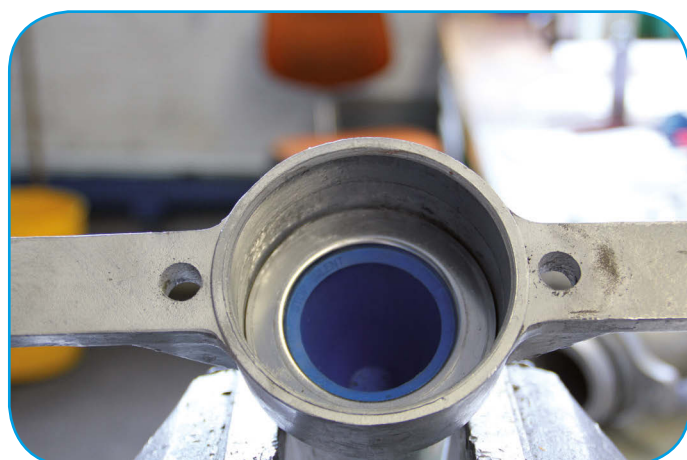
Zwischenflansch-KMR mit Dichtung in das Standrohr-Unterteil legen
