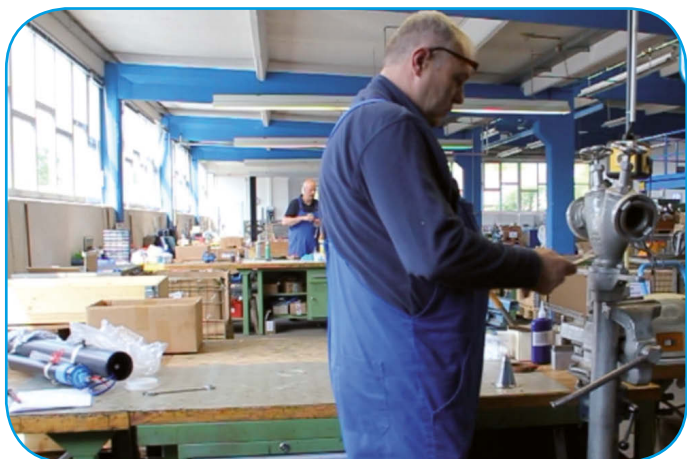
Demontage des Standrohr-Oberteils
