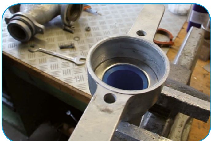
Sitz des Zwischenflansch-KMR im Standrohr-Unterteil
