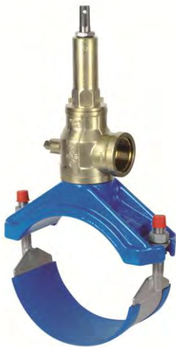
EWE-Kugelventil-Anbohrarmatur aus Si-Messing, für AZ-, ZM-Guss-, ZM-Stahl- und GFK-Rohr
