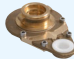
Reparatur-Führungs- scheibe, 1", aus Messing, inklusive O-Ring, 28x3 mm, aus NBR und 6kt Stiftschlüssel gemäß DIN 911 SW 5, für DN 25
